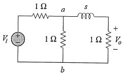
13. A). Determine the y parameters for the given two-port.
